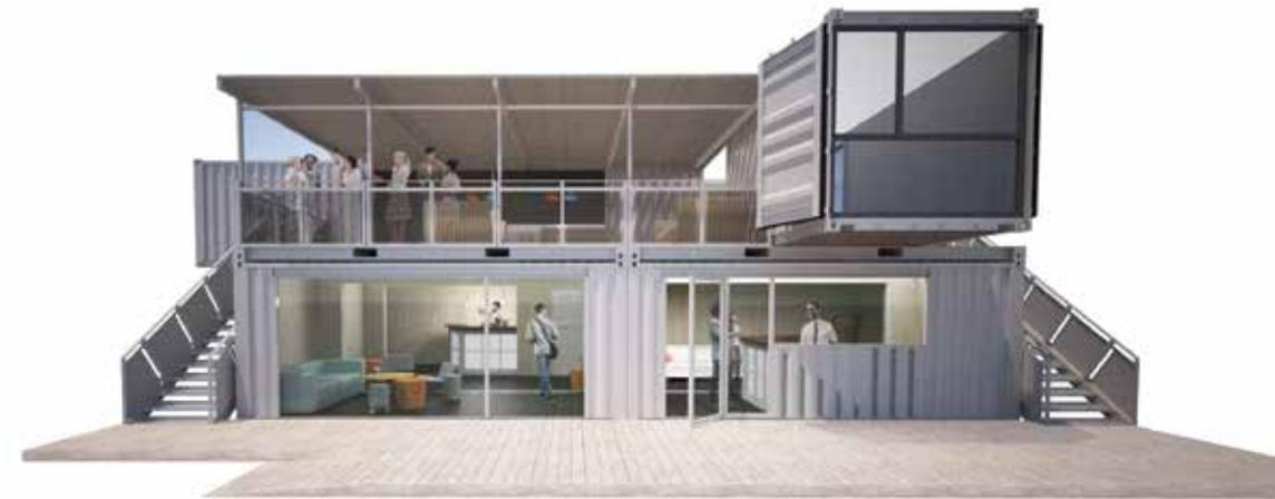
Als Erweiterungsvariante kann die Front des Club House, durch die seitliche Öffnung der Erdgeschosscontainer und den Einsatz einer Glasfassade, von außen einsehbar gestaltet werden.
